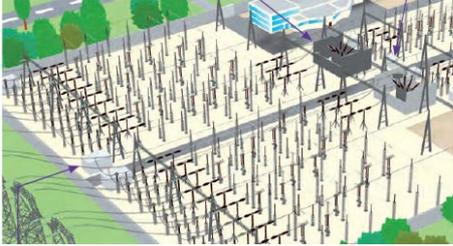
Depuis les grandes centrales de production où elle est produite, l'électricité transite sur le réseau de transport à haute et très haute tension en direction des zones de consommation. Elle passe par des postes électriques de transformation 400 000, 225 000 et 63 000 volts jusqu'au réseau de distribution.
